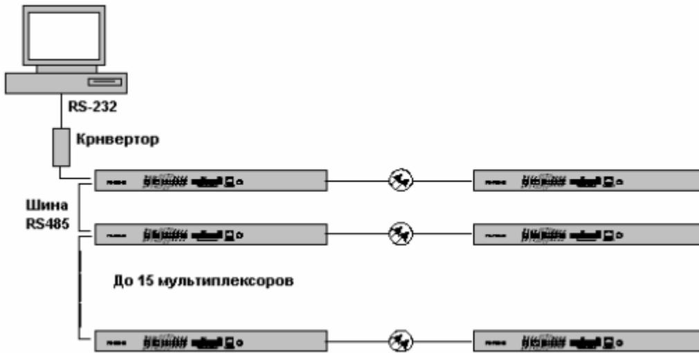
Рис. 1.7. Подключение мультиплексоров к ПК
